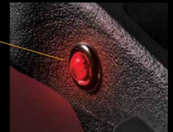
Le témoin SmartConnect™ LED situé sur le côté de la sellette s'allume en rouge lorsque le verrou est ouvert et en vert lorsque le verrou est fermé.
