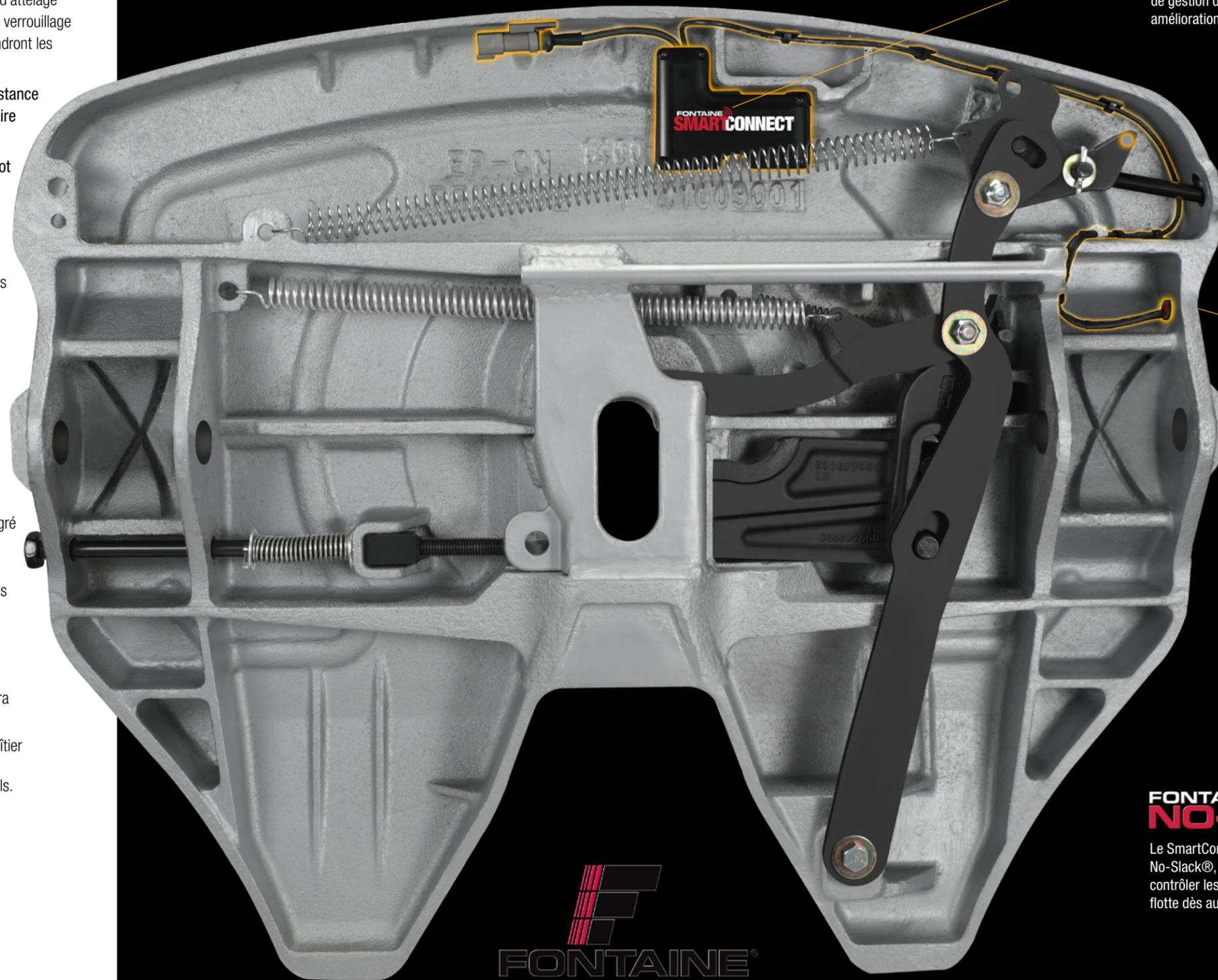
Le module de commande Fontaine SmartConnect™ offre une capacité de connexion câblée pour la communication de gestion de flotte et les futures améliorations logicielles.
