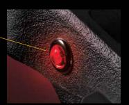
Le témoin SmartConnect<sup>MD</sup> LED situé sur le côté de la sellette s'allume en rouge lorsque le verrou est ouvert et en vert lorsque le verrou est fermé.
