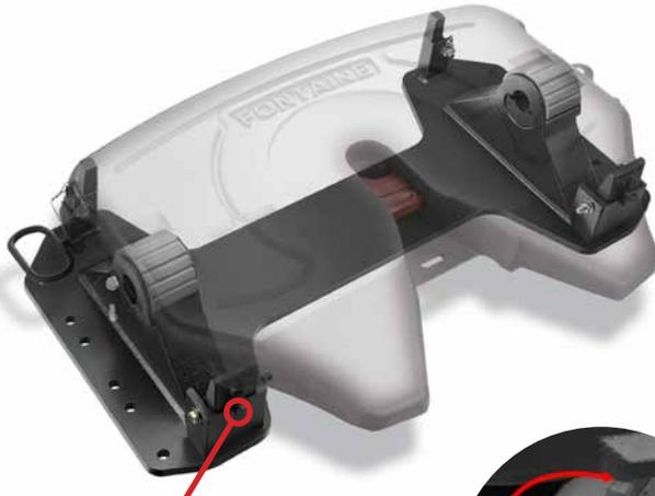
**Option sans inclinaison (NO-TILT) pour les applications de basculement du châssis: il suffit de faire basculer les quatre leviers du support pour empêcher la sellette d'attelage de basculer.**
