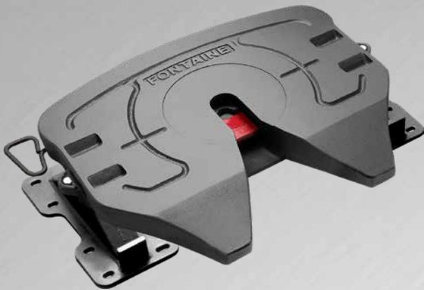
Fontaine ofrece ahora la alternativa al Holland FW35 - una quinta rueda de la serie Fontaine 7000 en FMAH estacionaria Soportes de montaje en marco con un patrón de montaje de 5 tornillos.
